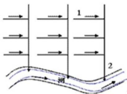
1 合流支管 2 合流干管 图1 直排式合流制
