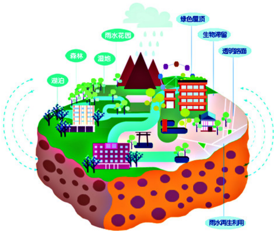
“海绵城市”是指城市能够像海绵一样，在适应环境变化和应对自然灾害等方面具有良好的“弹性”，下雨时吸水、蓄水、渗水、净水，需要时将蓄存的水“释放”并加以利用。
